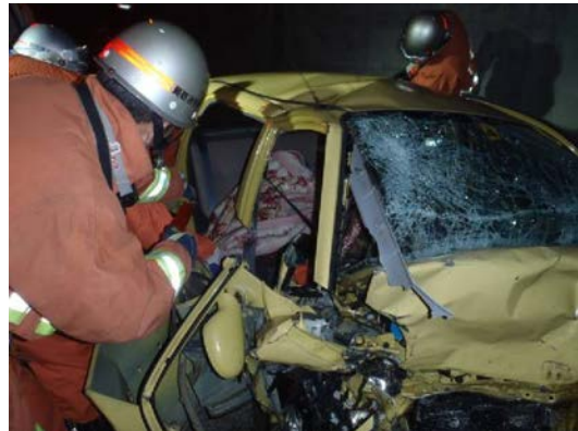
レシプロソーによりピラー部分を切断
