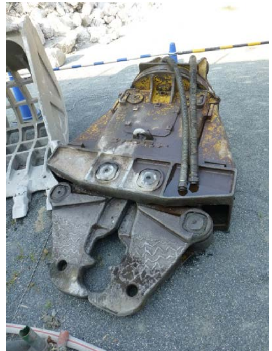
解体重機の先端アタッチメントの一例
