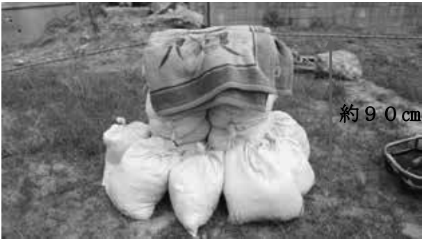
支点前方の土嚢積み上げ状況 ※6段積み上げにて高さ約90 cm
