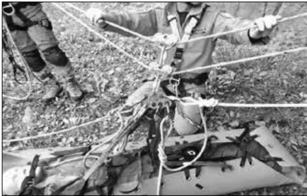
ロープは山中に携行することを優先に考え、軽量な11mmスタティックロープを、カラビナも同様の理由でアルミ製。
