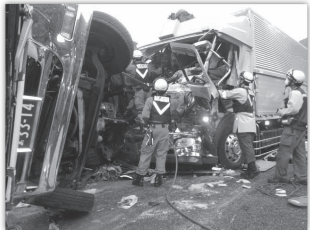
フロント部分からの引き離し状況
