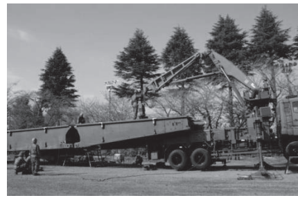
【写真 10：機動支援橋】
