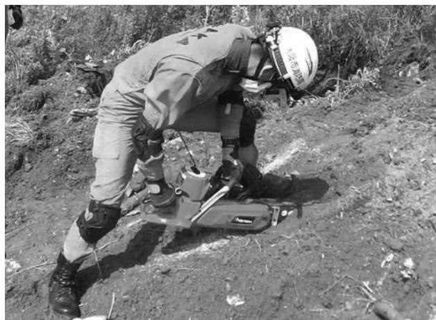
根切りチェーンソーは丸太でも問題なく切断できるため、土砂災害での木材の切断作業は根切りチェーンソーがより有効である。
