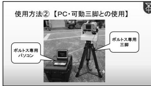
ポルトスは可搬式で、手に持って測定することができます。検知器自体に画面があり、化学剤を検知した場合は、左上の【検出】ランプが点灯します。
