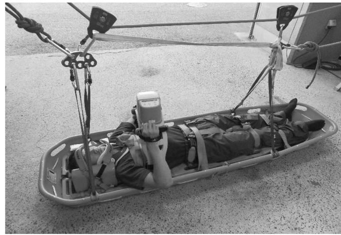
自動式心マッサージ器の高さが約63cmあるため、通常の一か所吊り担架の設定では担架ストラップが干渉するため、手首の負傷や効果的な胸骨圧迫ができない可能性がある。
