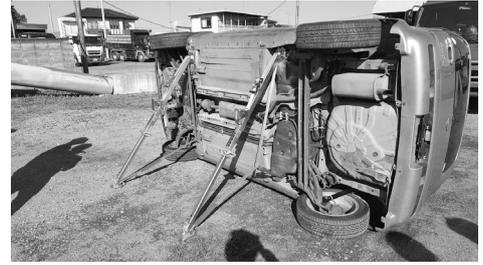
日割点検時、訓練用の車両に支柱器具を設定
