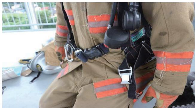
写真6 空気呼吸器腰バンドの外れ
