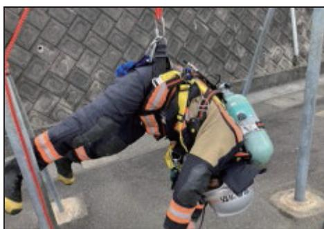
(墜落時の体勢・胴ベルト型墜落制止用器具)
