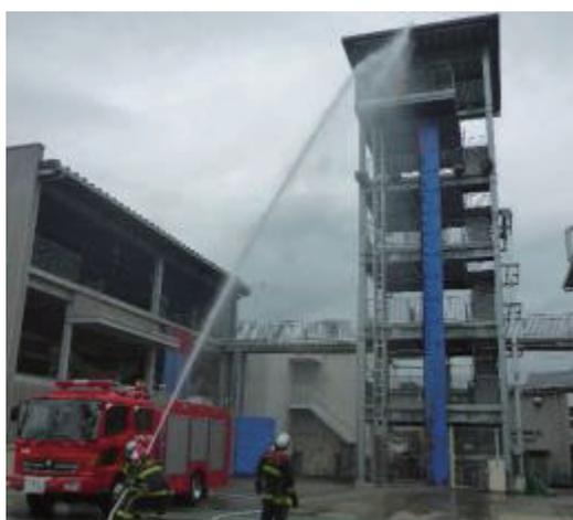
地上から6階（約19m）の天井に放水。クアドラノズル流量470m<sup>3</sup>が最も有効注水となり、次いでクアドラノズル流量360m<sup>3</sup>が有効。他は距離が届かず有効注水となり得なかった。
