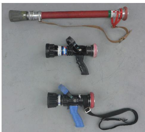
写真上からヴァリアブルノズル、デュアルマチックノズル、クアドラノズル。
