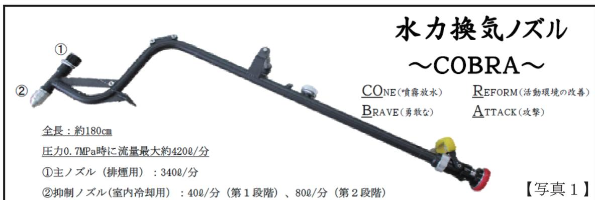
この資器材は水力換気を応用したもので、火災室内に進入せずに屋外からの設定で内部の排煙・排熱を行い、室内環境を改善することで、これまでよりも安全性を向上させた状況下で、早期の人命救助・消火活動を図ることができ、当局では、COBRAを使用した排煙・排熱活動を「水力換気システム」と呼んでいます。
