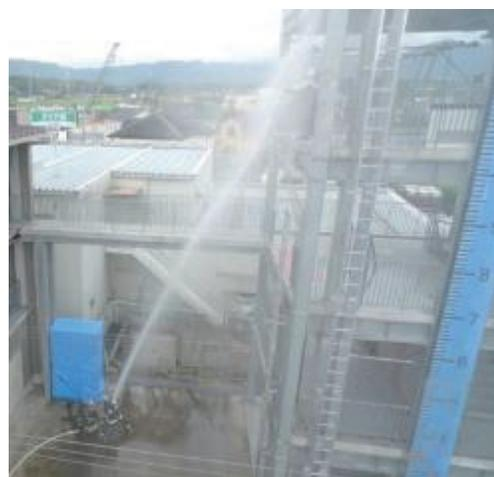
地上から4階（約13.5m）の天井に放水。各ノズルともに有効注水となり得たが、放水位置が建物から近いと間接放水が狙い難く、要救助者に直接放水する危険性が高くなる。
