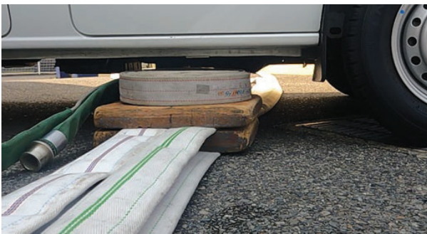
重量物の下に設定した状況
