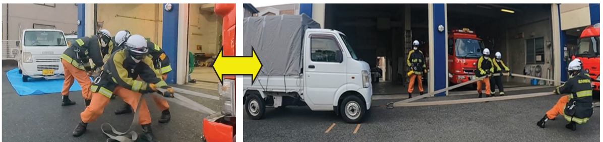
①ラチェット機構でホースの余長を取る
