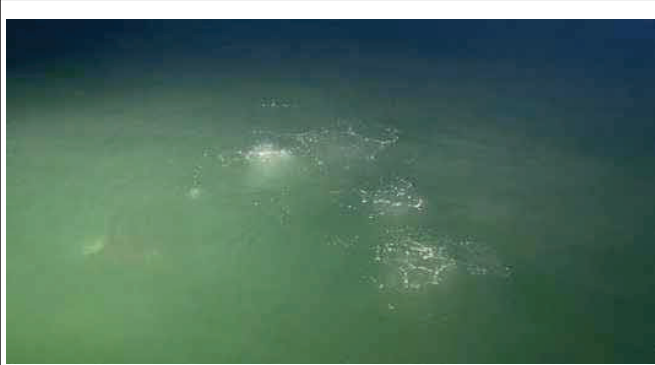
メタルハライドを使用した水面照射状況
