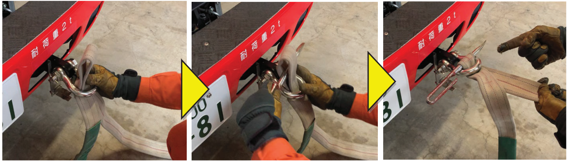
ホースの反対側末端を 金具側が上になるよう折り返して 下からフックに通す
