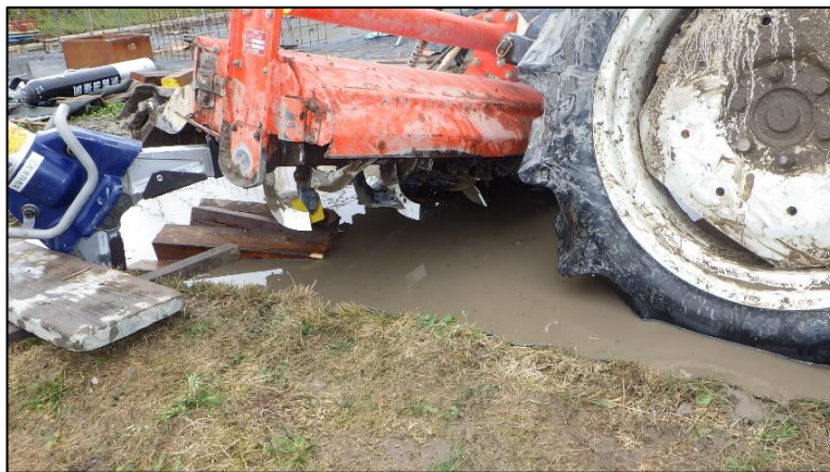
写真3 スプレッダーによるロータリーの挙上状況
