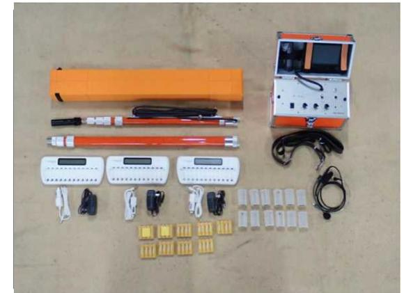
● 生存者捜索システム、小型ビデオスコープ及び伸縮式画像探索機は、倒壊した建物等の隙間にカメラ部分を差し込むことで内部を確認することができます。
