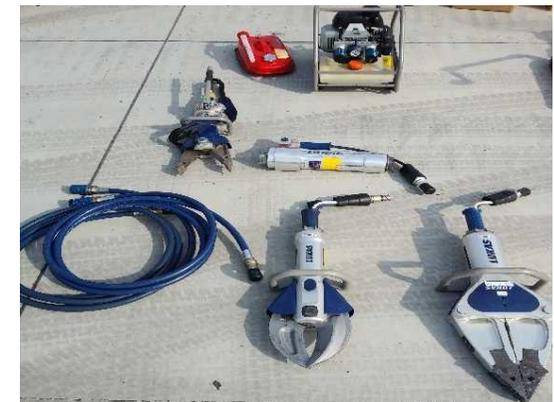
● 災害救助活動用バックホウは倒木や土砂等の除去、災害活動用コンベアセットは土砂の搬送、油圧カッター・油圧スプレッダーは油圧ポンプの力を利用して隙間を拡張したり金属板等を切断するために使用します。
