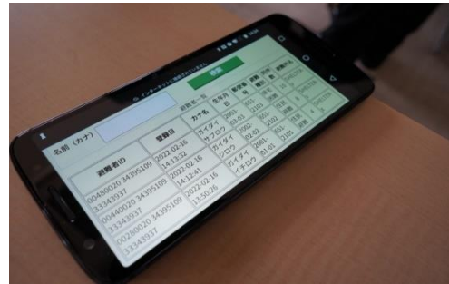
図 28 災害対策本部に戻った「メッセージフェリーデバイス」から避難者情報が災害対策本部のネットワークに同期されている状況
