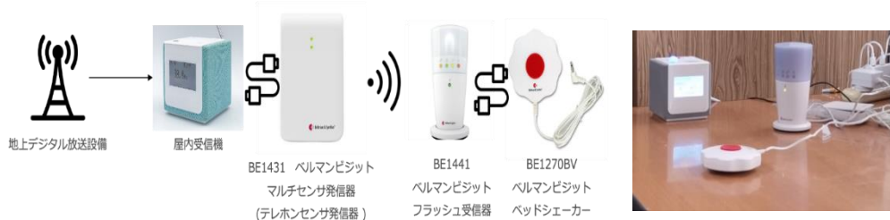
図 37 屋内受信機とマルチセンサ発信器等との接続イメージ
