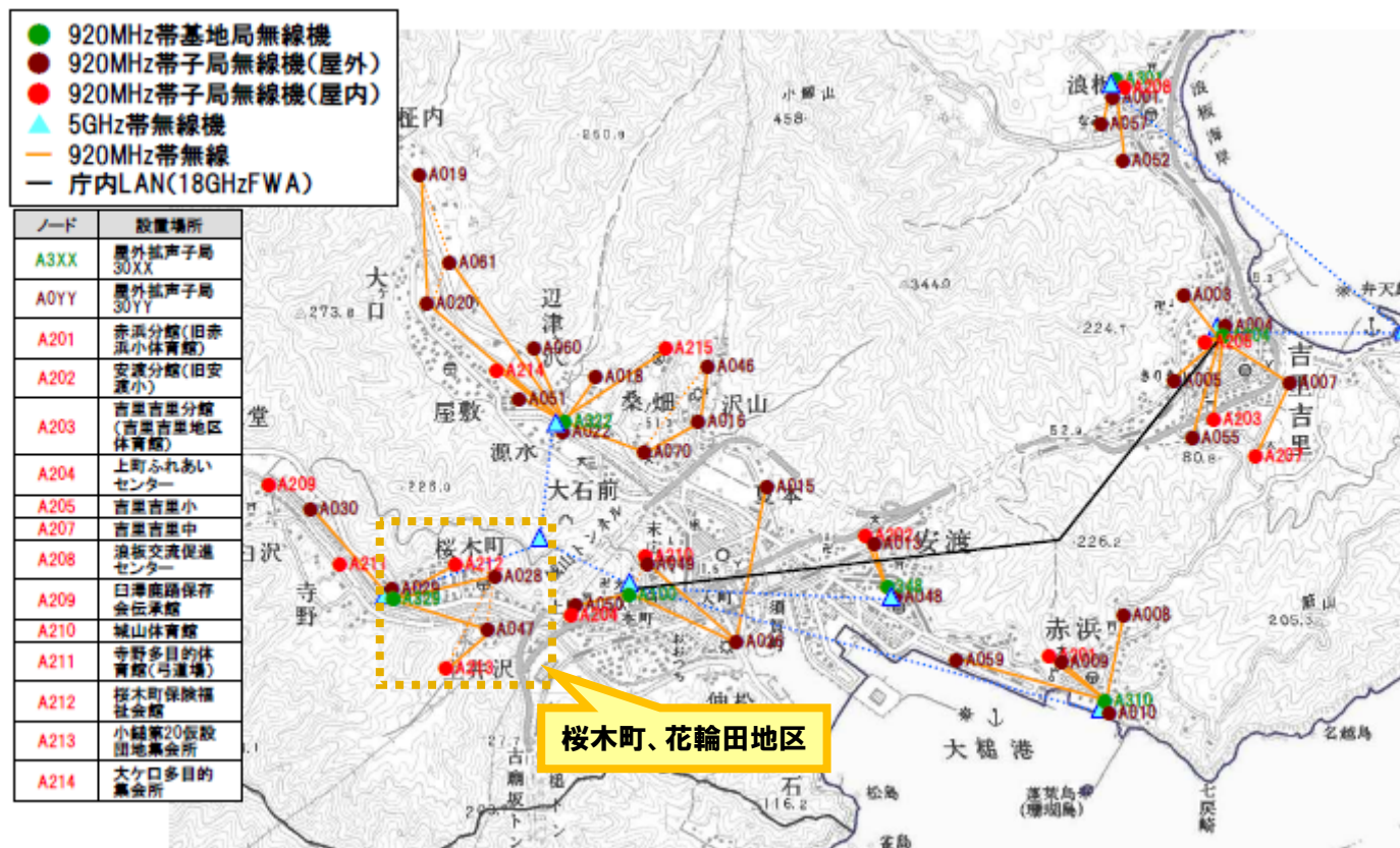
図2. 1 b 無線機設置場所と無線回線構成（ネットワークポロジ）
