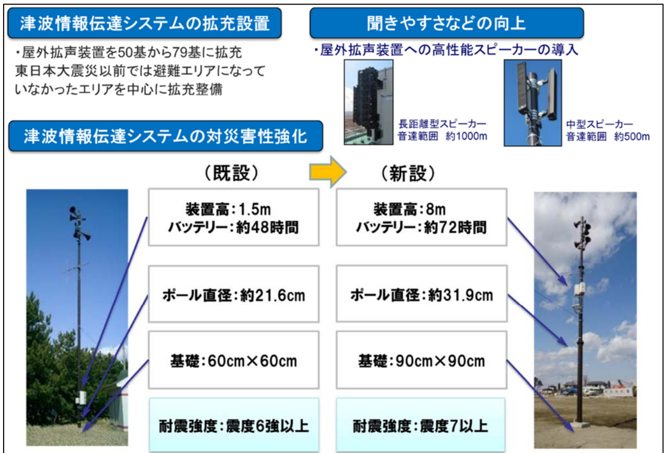
図2 屋外拡声装置震災後の強化・拡充
