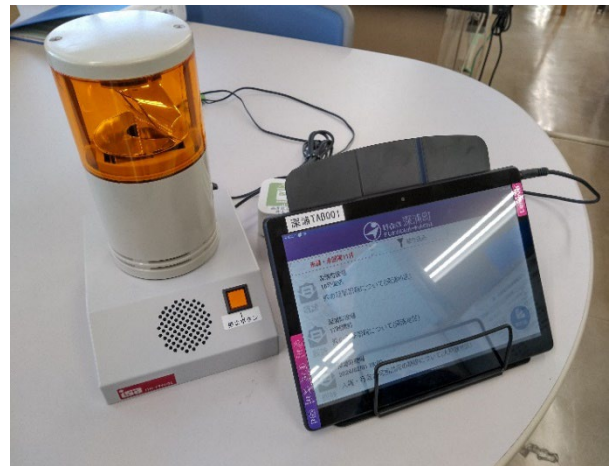
<図2・戸別受信機（左・従来型、右・警告灯付タブレット型）> (出典 深浦町提供資料)
