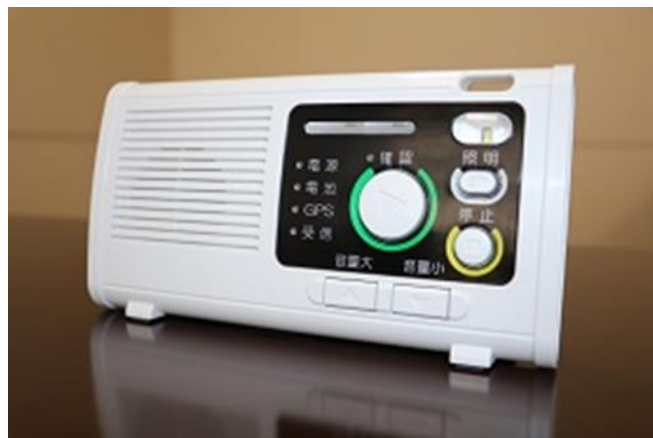
図 23 携帯電話 IP 網を用いた受信端末（例）
