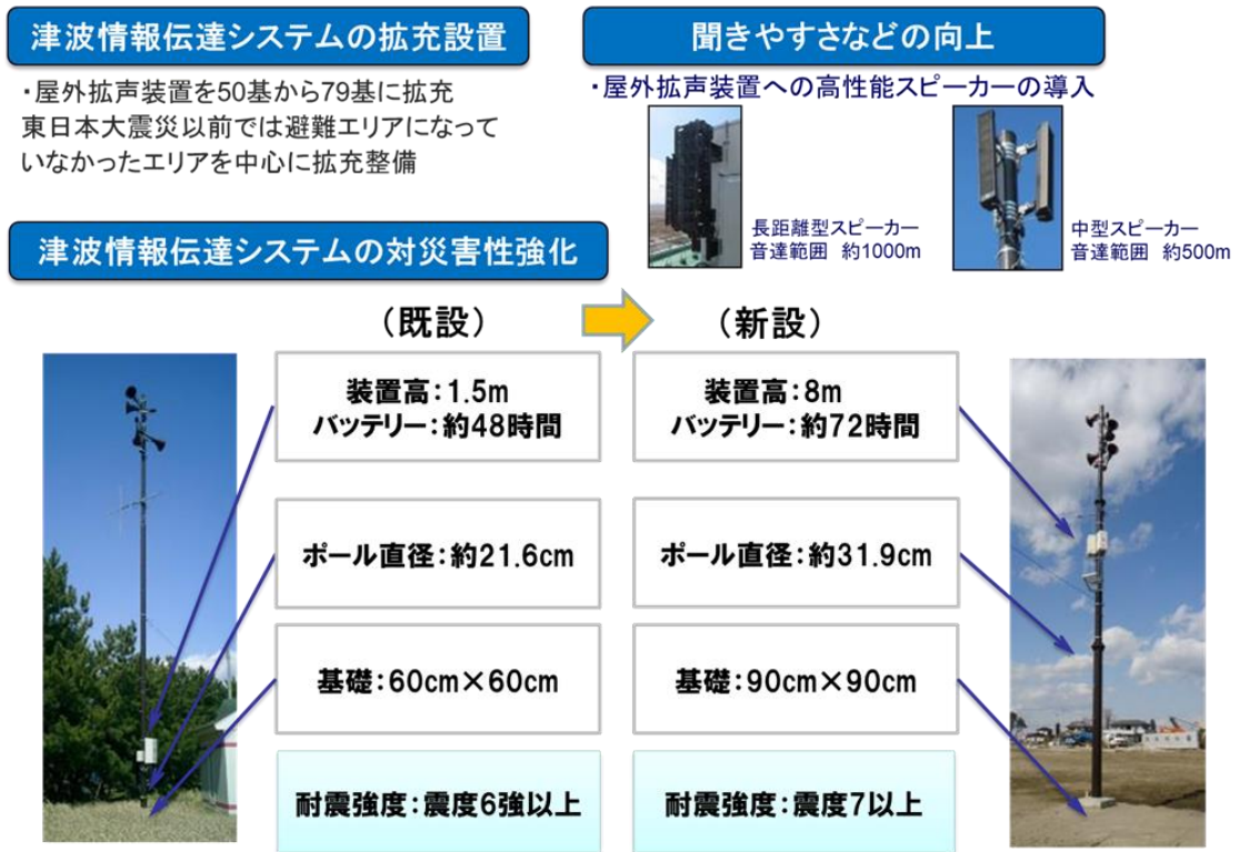
図45 仙台市の屋外拡声子局の機能強化（出典：宮城県仙台市資料）
