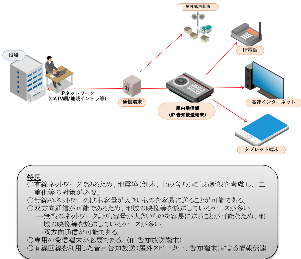
図 27 IP 告知システムのイメージ図とその特長
