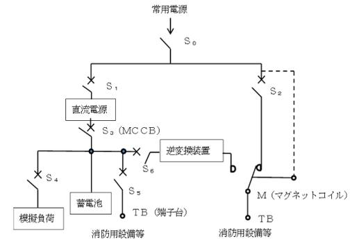
(点検においては、S<sub>0</sub>、S<sub>2</sub>、S<sub>6</sub>を開放しS<sub>4</sub>を閉鎖する。)
