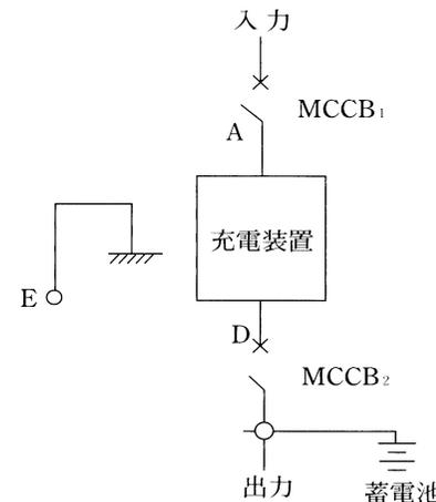
第25-4図 絶縁抵抗測定位置の例
