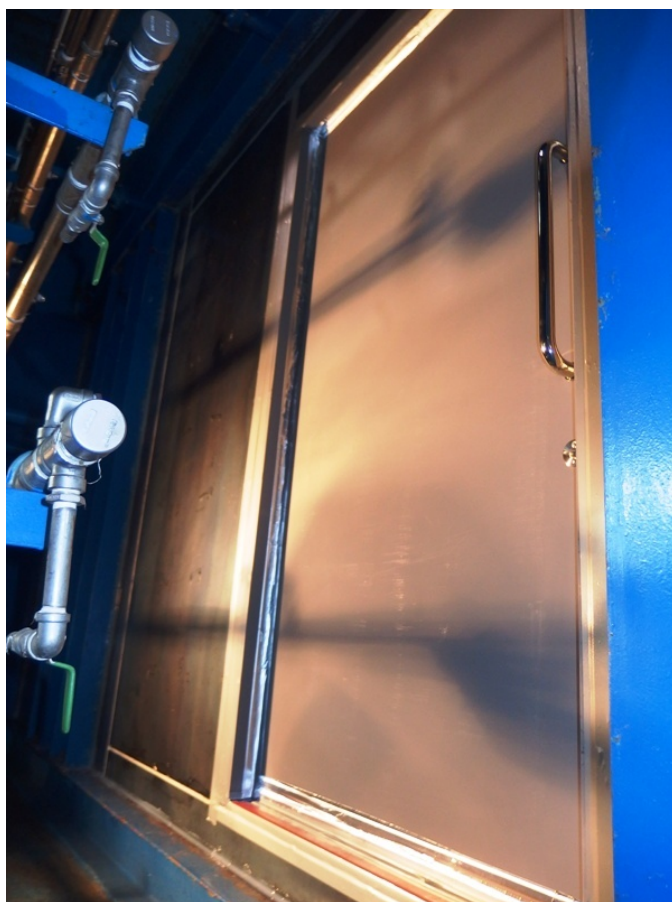
写真-14 試験体（鋼製吊り戸：表面アルミテープ処理仕様） 四周にアルミテープ処理
