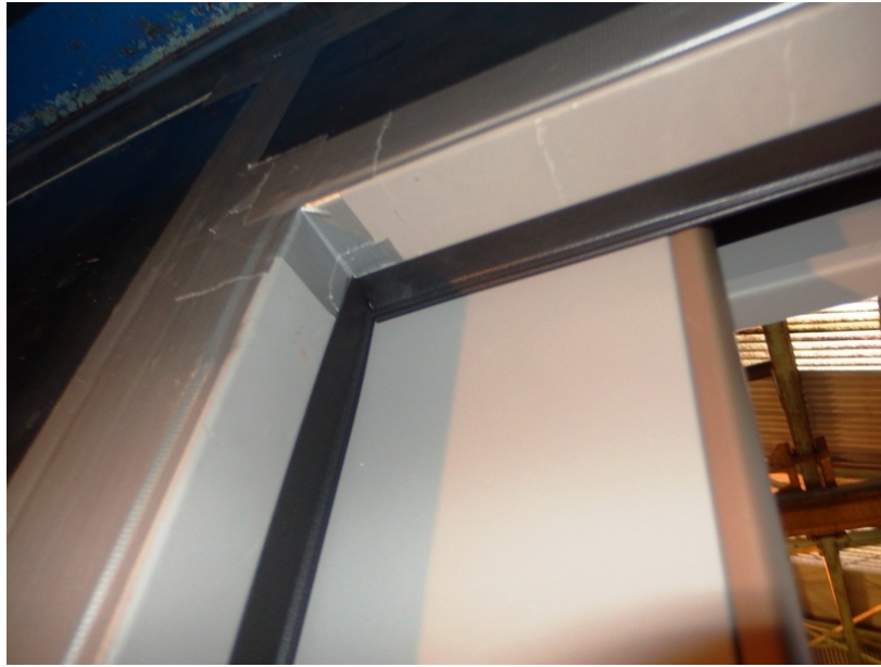
写真－7 試験体（鋼製吊り戸：気密ゴム追加仕様） 上枠及び召合せに設置した気密材
