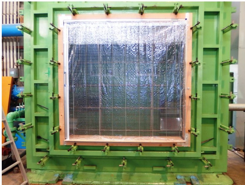
写真－1 試験体（遮煙カーテン：標準仕様） 表面側
