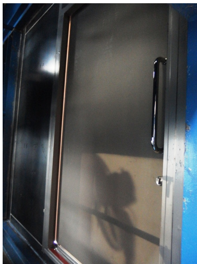
写真-4 試験体（鋼製吊り戸：標準仕様（気密材無し）） 表面側
