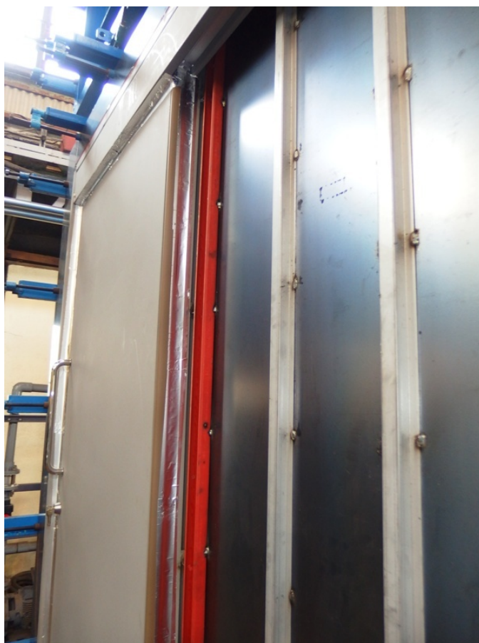
写真-13 試験体（鋼製吊り戸：裏面アルミテープ処理仕様） 召合せにアルミテープ処理
