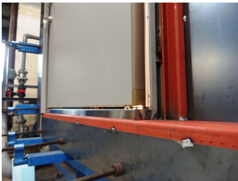
写真－5 試験体（鋼製吊り戸：標準仕様（気密材無し）） 下枠と戸の状況
