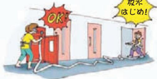
出火箇所に接近した操作員の放水準備ができれば「放水はじめ!」の合図で、消火栓の開閉弁を開放し放水します。
