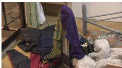
電気ストーブの実験では、地震後に電気が復旧し、周囲の可燃物を過熱する通電火災を再現しました。
