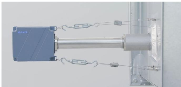
専用アプリにて機器を操作し、ダクト内部の撮影、温度測定を行う。
