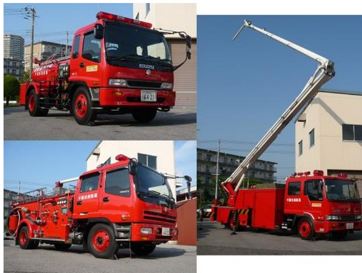
写真 1-1 三点セット（左上：泡原液搬送車、左下：大型化学消防車、右：大型高所放水車）
