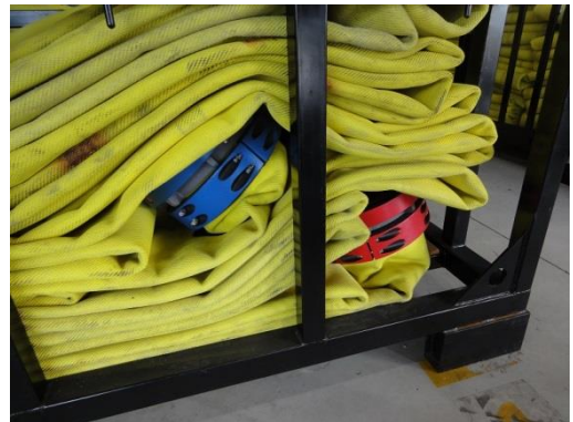
写真 2-14、2-15 コンテナに記載された凡例及び色分けされた結合金具の状況
