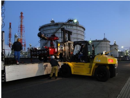
写真 2-10、2-11 フォークリフトによる大容量泡放水砲の積載状況
