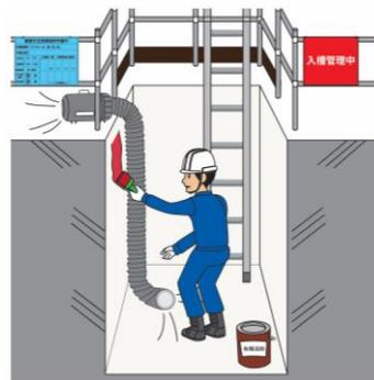
可燃性蒸気の滞留による着火の危険性をなくすため、換気の徹底や排風機を使用することが重要です。
