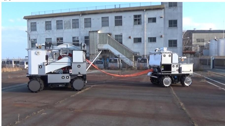
放水砲ロボットの自律走行とホース延長ロボットの自律追従走行
