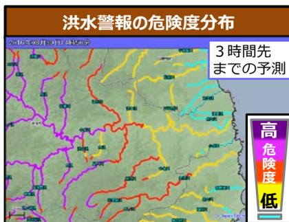
平成 29 年 7 月 4 日から気象庁による提供が開始された新たな防災気象情報で、雨が河川に集まり流れ下る量を算出した「流域雨量指数」を基に、水位周知河川及び「その他河川」における 3 時間先までの洪水害発生の危険度の高まりを 5 段階に判定し、地図上で河川毎に河川名と合わせて色分けして表示。
