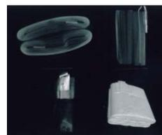
また、本調査結果を受け、製造事業者側からは同型カード端末約4,600台のバッテリー交換や今後製造する同型カード端末のバッテリーの仕様変更等の再発防止対策が実施され、類似火災防止に大きく寄与した事案である。
