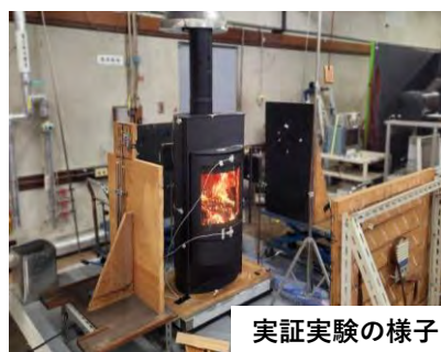
鋼板と蓄熱材で構成された 薪ストーブ
