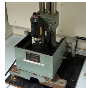
落球式打撃感度試験 (第1類確認試験)
