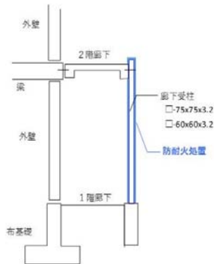
鋼製柱+防火処置 (準耐火要求ありの場合)
