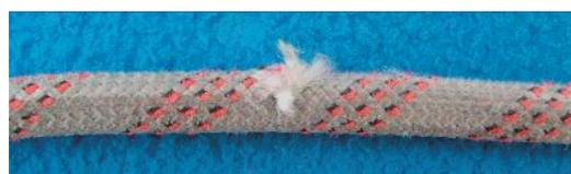
外皮の磨耗・破断
