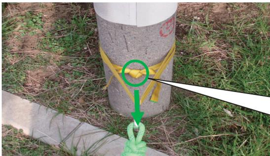
結索部を牽引方向へ合わせることで、結索部に荷重がかかりにくくなる。
