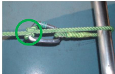
巻き結びにより自己確保の長さを調整
