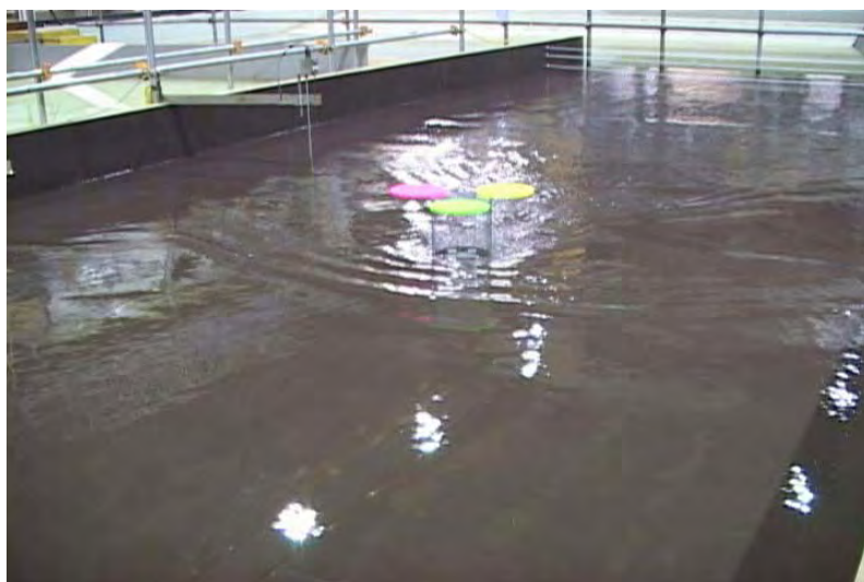
写真 4.2-11 Case2-2-3 停止したタンク
