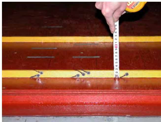
写真 2.2-1 波圧計設置状況
