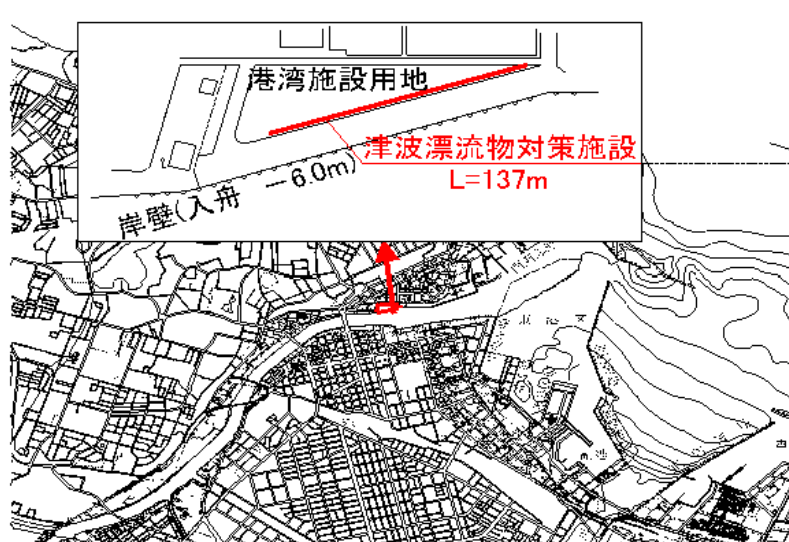
図 2.3-4 津波漂流物対策施設設置箇所（文献 3-1 より引用）
