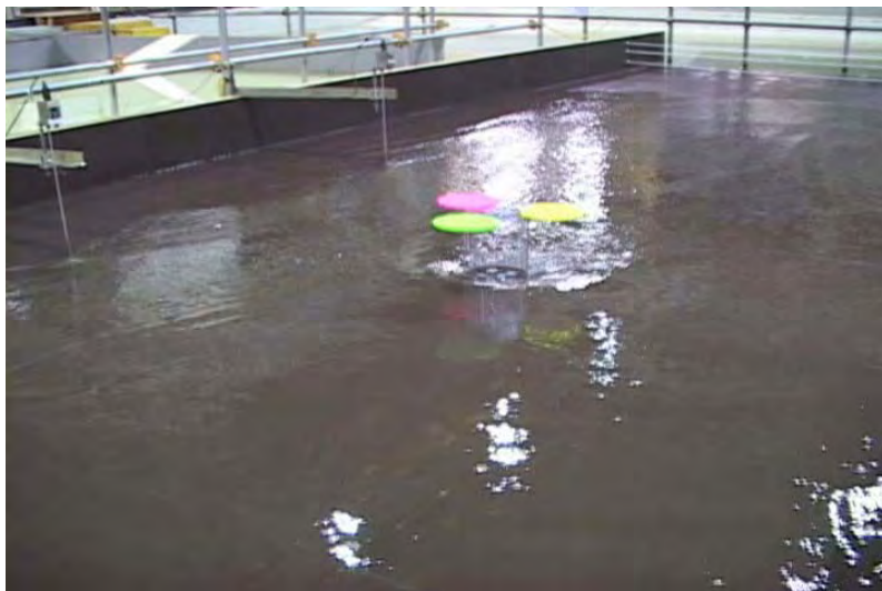
写真 4.2-10 Case2-2-3 動摩擦力を受けて減速するタンク
