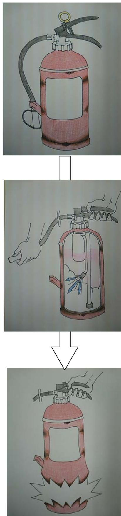
図5. 消火器破裂フロー
