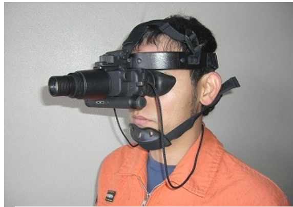
図7-4 夜間用暗視装置使用中の例
