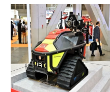
【無人走行放水ロボット】
