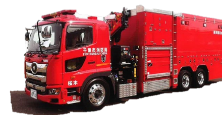
【海水利用型消防水利システム】
