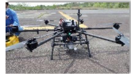
【ドローンレーザー計測システム】
