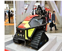
【無人走行放水ロボット】
