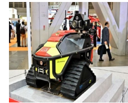
【無人走行放水ロボット】
