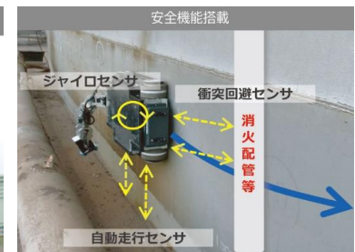
【点検ロボットを用いたタンク点検のイメージ図】
