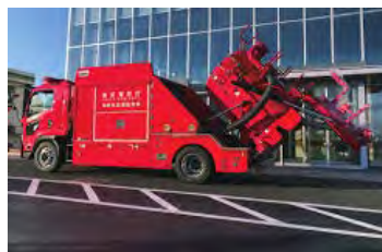
※吸引した土砂は後部から容易に排出可能
