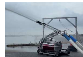
【無人走行放水ロボット】
