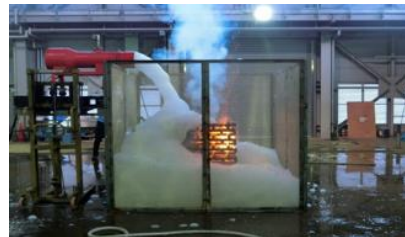
【泡消火実験の様子】
