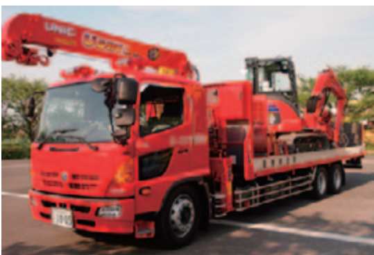
重機及び重機搬送車
