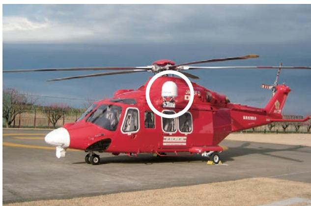
ヘリサットアンテナの搭載状況
