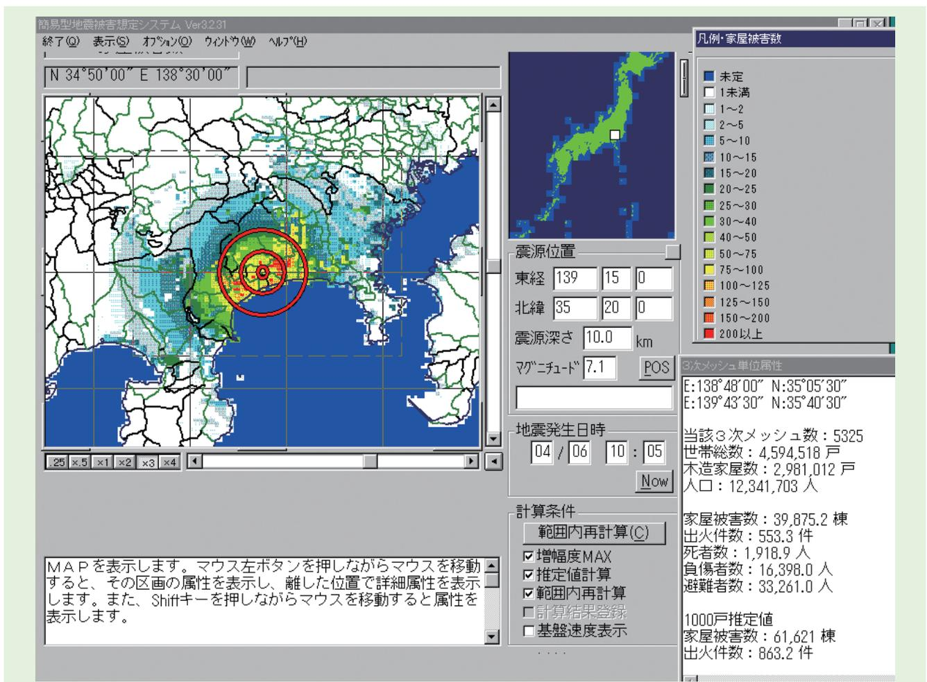
ている点震源を用いていることから、本システムは平成23年東北地方太平洋沖地震のような一定規模を超えた巨大地震への適用には限界を有している。
