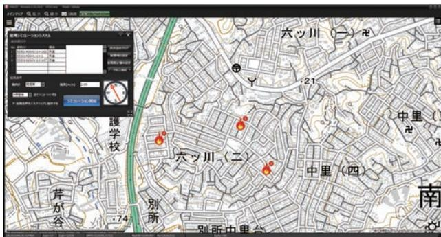
「広域の延焼被害予測を高速で実行可能なシミュレーションモデルの構築に関する研究」では、現在よく用いられている延焼クラスタの作成方法が片方向の延焼を取扱う場合に正確性に欠けると考えられることから、延焼被害を及ぼす関係を用いて延焼クラスタを作成して広域の延焼被害を予測する手法について検討するとともに、検討した手法を用いて一部の地域の延焼クラスタデータを作成した。
