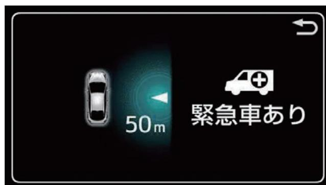
第6-13図 緊急車両存在通知により救急車を認識した例
