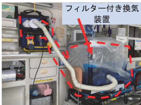
第 6-10 図 フィルター付き換気装置
