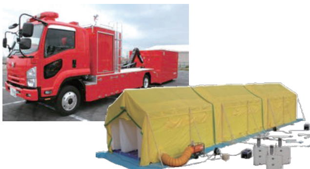
大型除染システム搭載車
