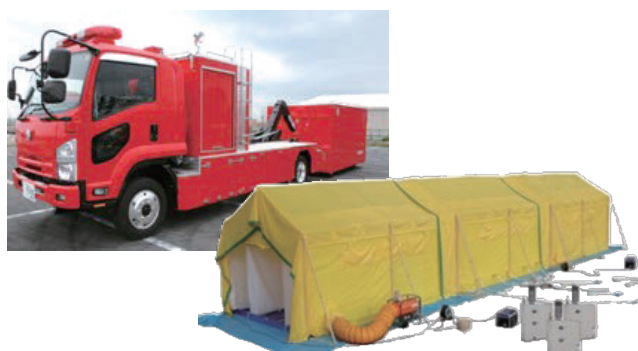
大型除染システム搭載車
