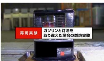
この実験は、故意に燃料タンクにガソリンを給油して着火した際の映像です。はじめのうちは、異常なく燃焼していますが、これは、もともと石油ストーブの芯に染み込んでいた灯油が燃焼しているからにすぎません。
