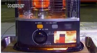
揮発性が高いガソリンは、使っているうちに給油タンク内で揮発し、タンク内部の圧力を上昇させます。そのためガソリンがタンクの外に浸み出していき、ある瞬間に突然引火してしまうのです。
