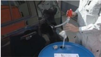
■ドラム缶からクルマへのガソリン給油する正しい方法
