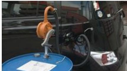
また、運搬や保管には、灯油用ポリタンクは使用せず、金属製の携行缶を用いること。
