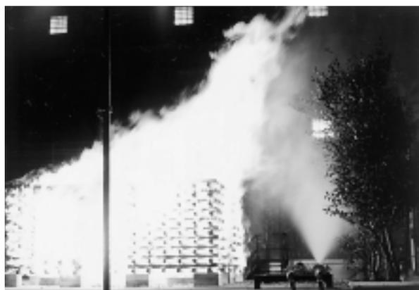
樹木と水幕の併用による放射熱の遮断実験（高さ2 mの樹木の火災側下方から平均粒径 $100\mu\text{m}$  の水を噴霧している）
