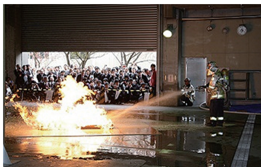
可燃性液体火災の消火実験
