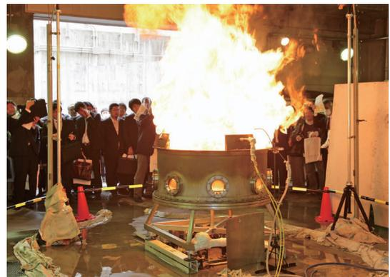
写真3 泡消火のメカニズム解明のための燃焼実験
