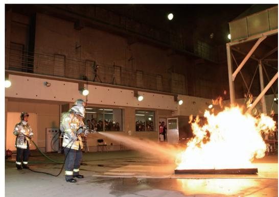
写真4 2流体ノズルを用いた消火の実演
